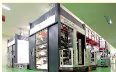
日野軟包材工場の水性フレキシソ 10 色印刷機
