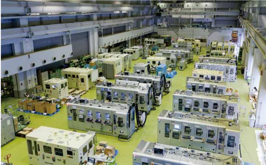
TOWAは、半導体のチップを樹脂でくるんで保護する装置を製造しています。半導体はチップのままでは熱や埃に弱いので保護する必要があります。半導体メーカーはこの装置をTOWAから購入して半導体を製造します。TOWAはこの分野の装置で世界トップシェアを誇っています。
